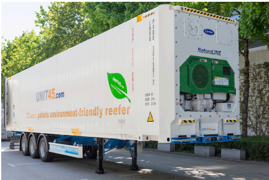
Der neue grüne Reefer von UNIT45, wie er bei Transport Logistic vorgestellt wurde, verwendet eine NaturaLINE-Kälteanlage, Niedrig-GWP-Schaum und umweltfreundliche wasserbasierte Beschichtungen.
