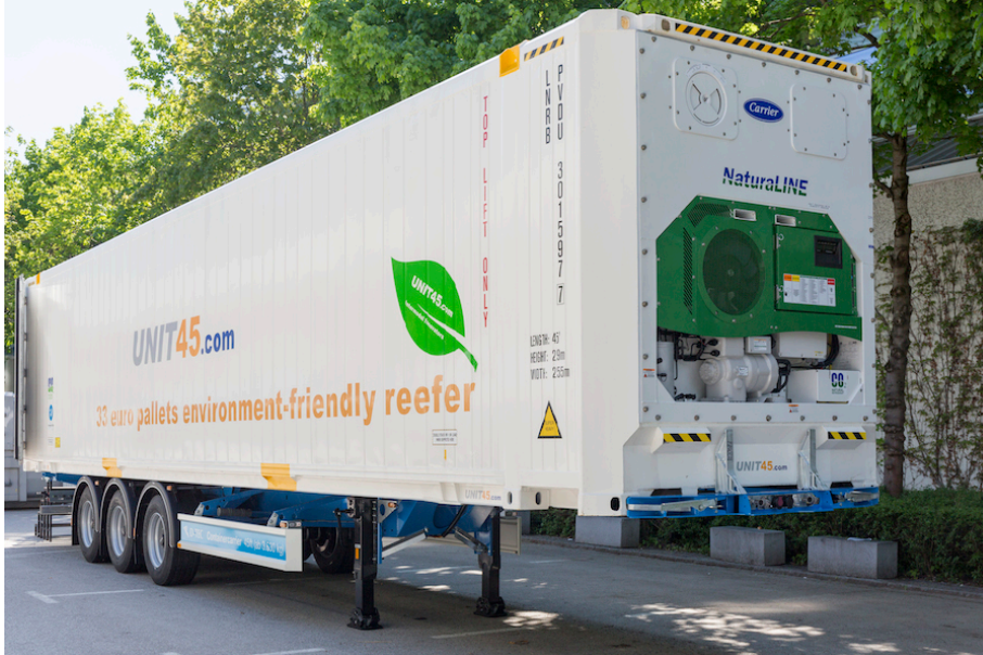
El nuevo contenedor refrigerado ecológico de UNIT45 en su presentación en el evento de Logística del Transporte, éste emplea una unidad de refrigeración NaturaLINE, espuma de bajo coeficiente GWP y revestimiento de pintura al agua ecológicamente sostenible.
