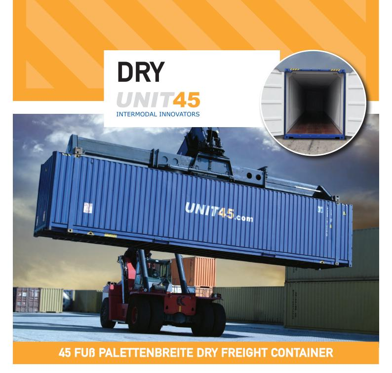
Der 9ft 6in hohe palettenbreite (palletwide) Dry Freight Container bietet die größte Nutzkapazität und Payload unter den Containern mit dem Standard-45ft-Containerdesign. Durch Verwendung von hochfestem Stahl und leichten Bodenmaterialien wurde ein extrem geringes Leergewicht erreicht.
